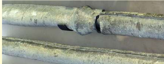
Römische Wasserpfeife aus gelöteten Bleistreifen (Antikmuseum von Arles und der Provence)
