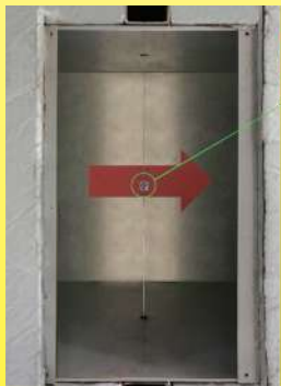
Position der Thermoelemente oder Thermokolben-Mechanismen im Luftstrom zur Messung der Grenztemperatur
